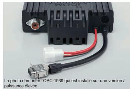
La photo démontre l'OPC-1939 qui est installé sur une version à puissance élevée.
