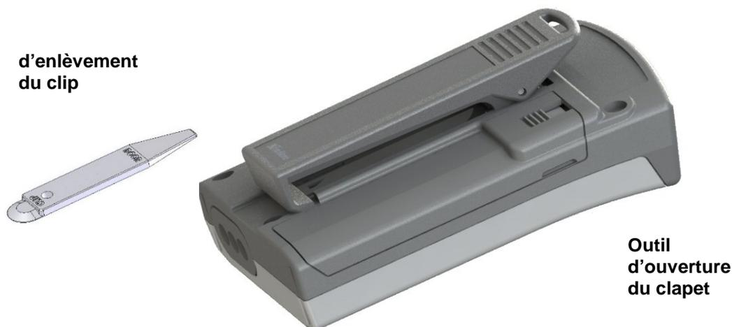
Tenir le pager dans une main, la face avant dirigée vers le bas. A l'aide de votre pouce ou de votre index, faites doucement coulisser le fermoir dans la direction indiquée par la flèche. Insérez l'extrémité de l'outil enlèvement de clapet fourni ou une lame fine similaire (par exemple, un petit tournevis) dans l'ouverture sur le côté du clapet et soulevez doucement pour l'extraire de son encoche.
