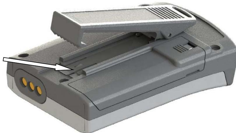
Insérez l'outil à lame du clip ou un appareil similaire sous le bord du support tel qu'indiqué par la flèche et soulevez-le du corps du pager. Une fois le support enlevé, faites coulisser doucement le clip vers le bas du pager jusqu'à ce qu'il s'extrait du corps principal.
