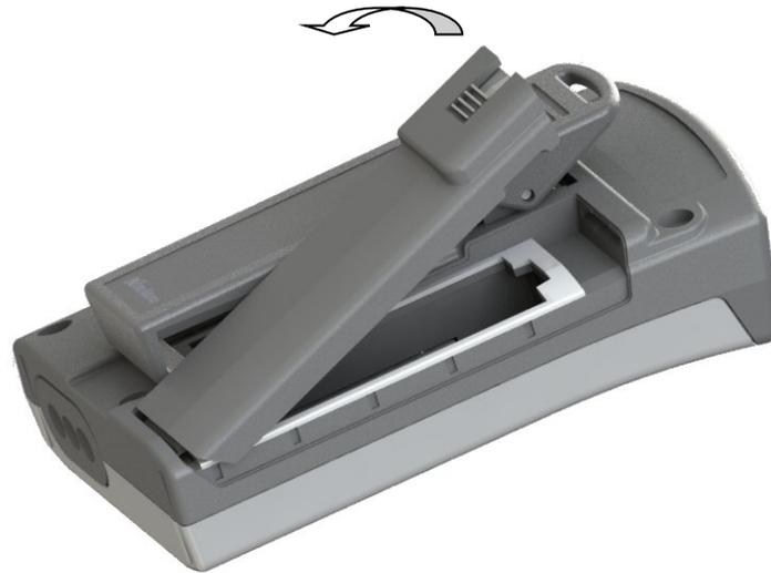
Soulevez doucement et extrayez le clapet de batterie du corps principal dans la direction indiquée, en faisant bien attention à ne pas endommager le joint en caoutchouc qui se trouve sur le bord du compartiment de batterie.
