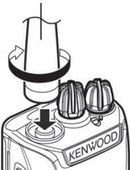
Vissez l'antenne sur le connecteur au sommet de l'émetteur-récepteur en tenant l'antenne par la base et en la tournant dans le sens horaire jusqu'à la fixer correctement en place.
