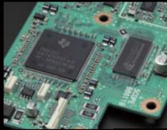
Portée DSP TMS320C6745 de Texas Instruments Virgule flottante 32 bits 2250 MFLOPS Fréquence d'horloge de 370 MHz
