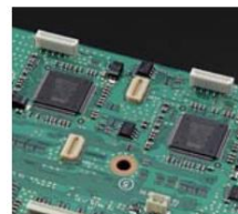
Transmetteur/ Récepteur DSP (à gauche) et Récepteur DSP (droit) ADSP-21489 de Analog Devices DSP 32 bits à virgule flottante 2400 MFLOPS Fréquence d'horloge de 393 MHz
