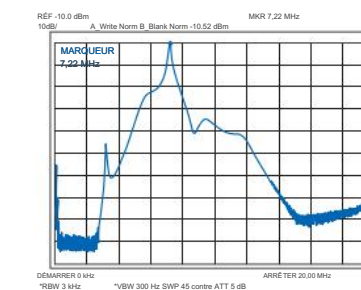
Caractéristiques de la bande passante entre l'antenne et le présélecteur (à la sortie du présélecteur)
