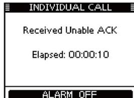
Appuyez sur [ALARM OFF] pour arrêter l'alarme. Appuyez ensuite sur [EXIT] pour revenir au canal d'exploitation (avant d'accéder à l'écran MENU).
