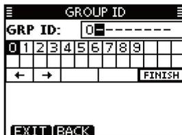
e Saisissez l'ID de groupe souhaité de la manière suivante : • Sélectionnez le numéro souhaité à l'aide de [Y]/[Z]/[Ω ]/[=]. • Appuyez sur [ENT] ou composez le cadran pour le régler. • Pour déplacer le curseur, tournez le cadran ou sélectionnez l'une des flèches, « ← » ou « → », puis appuyez sur [ENT] ou composez.
