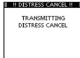
t Le canal 16 est automatiquement sélectionné.
