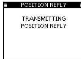
//// Lorsque « POSITION ACK » est réglé sur « Auto TX », l'émetteur-récepteur répond automatiquement à l'appel. Dans ce cas, les appels TX et RX sont stockés dans les dossiers Transmis et Reçus.
