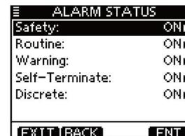
e Tournez le cadran pour régler le réglage de l'alarme sur « ON » ou « OFF ».
