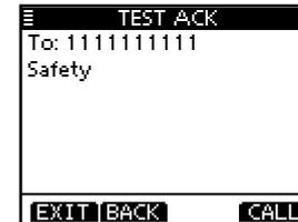
Lorsque "TEST ACK" est réglé sur "Auto TX", l'émetteur-récepteur répond automatiquement à l'appel. Dans ce cas, les appels TX et RX sont stockés dans les journaux d'appels transmis et reçus.
