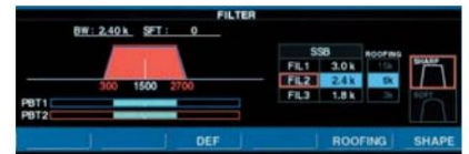
Exemple de réglage PBT de jumeau numérique
