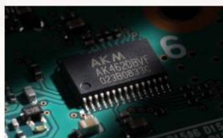
<Convertisseur AN/NA> AK4620B Signal ADC/(Bruit+Distorsion) : 100dB Plage dynamique ADC, S/N : 113dB Signal DAC/(Bruit+Distorsion) : 97dB Plage dynamique DAC, S/N : 115dB
