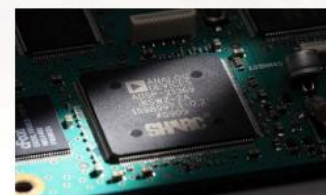
<Unité DSP> ADSP-21369 Vitesse d'horloge interne : 333 MHz DSP 32 bits à virgule flottante Max. performances : 2 000 MFLOPS
