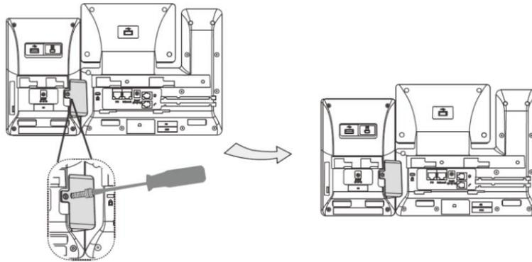
Si vous souhaitez connecter deux modules d'extension ou plus, retirez le gel de silicone et connectez deux modules d'extension comme ci-dessous.
