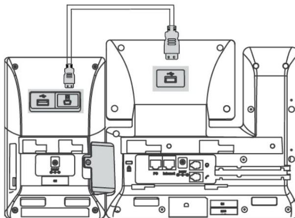
Si vous connectez deux modules d'extension, connectez la prise USB du module d'extension précédent et la prise mini USB du module d'extension suivant à l'aide d'un autre câble fourni. De liaison deux modules d'extension sur un seul téléphone hôte est illustré ci-dessous :
