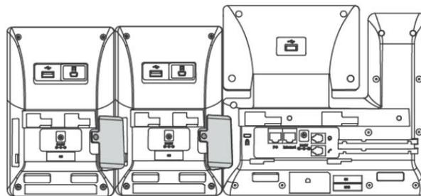
4. Connectez la prise USB du téléphone hôte et la prise mini USB du module d'extension
